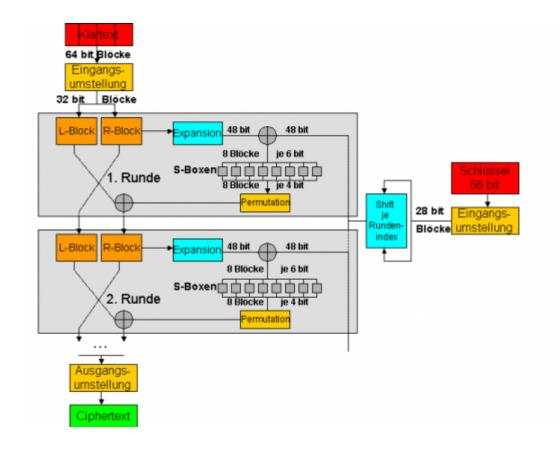
Zur Entschlüsselung muß lediglich der Algorithmus in umgekehrter Reihenfolge durchlaufen werden. Da der DES bereits Mitte der 90er durch sog. Brute-Force-Attacken (einfaches Durchprobieren aller möglichen Schlüssel) geknackt werden konnte wurde als Ersatz der Triple-DES oder 3DES eingeführt. Hierbei wird ein 168Bit Schlüssel verwendet, welcher in drei 56Bit Schlüssel zerlegt wird. Anschließend führt man dreimal eine einfache DES Verschlüsselung mit diesen Teilschlüsseln durch.
