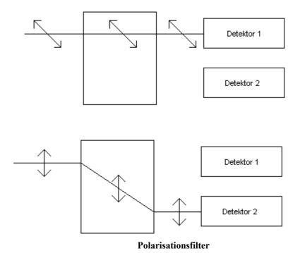
Horizontal polarisiertes Licht wird in Detektor 1, vertikal polarisiertes in Detektor 2 gelenkt.
